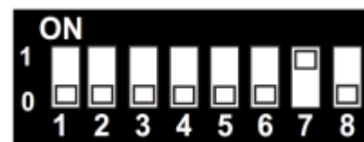
DIP-innstilling for kun flash med EN54 godkjent flashmønster
