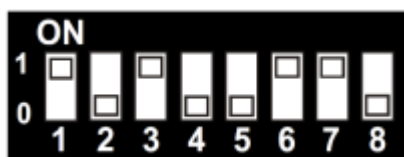
DIP-innstilling for Nortek Standard Tone og EN54 godkjent flashmønster
